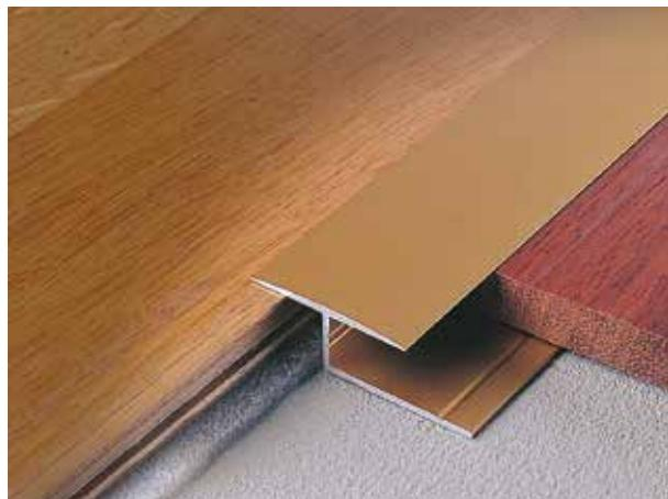
Unión entre pavimentos flotantes. La forma y el tamaño del perfil permiten la necesaria dilatación de las superficies subyacentes. El espesor reducido del perfil a la vista lo hace ideal también como conexión de dos pavimentos a nivel del umbral porque no crea espesor debajo de la puerta.
